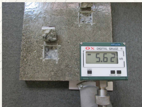
2か所試験平均6.27kNで母材破壊しています 母材破壊をしないと水分が上がれません
