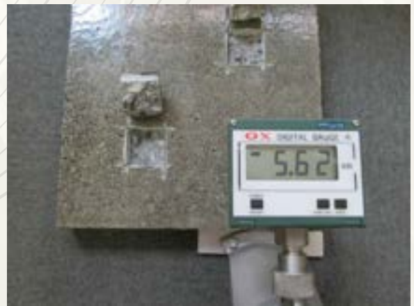
2か所試験平均6.27kNで母材破壊しています 母材破壊をしないと水分が上がれません
